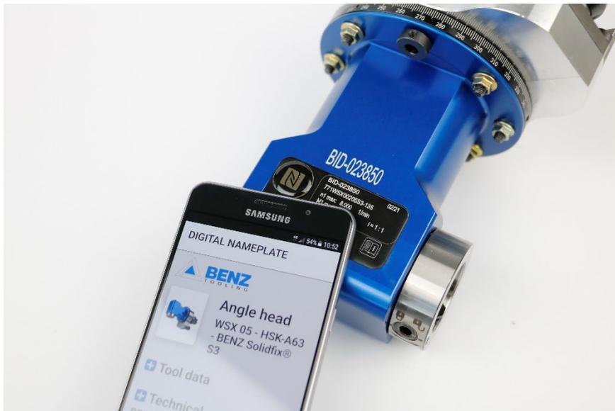
**Bild 4:** Alle Werkzeugdaten auf einen Blick mit dem digitalen Typenschild BENZ i.tag
